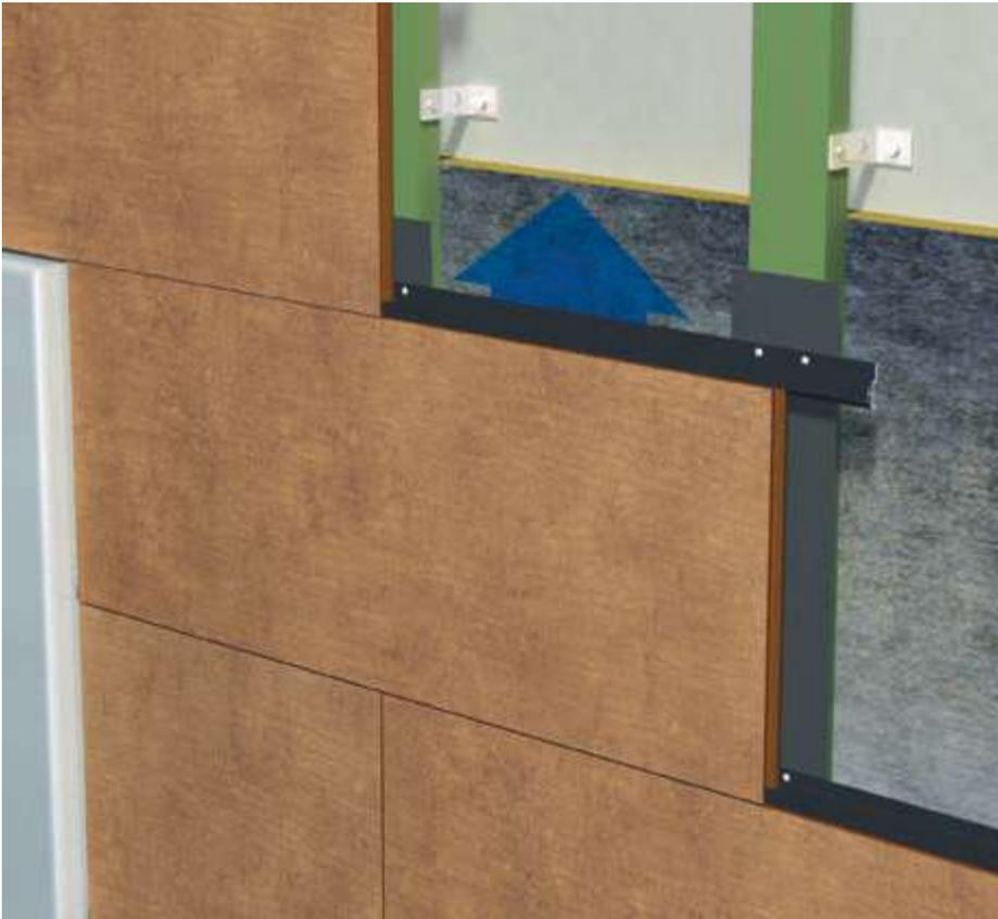
Los módulos ME05 estándar se entregan listos para instalar conjuntamente con los perfiles horizontales, para fijarlos a los perfiles verticales de aluminio o madera (no suministrados por FunderMax). Se debe dejar una cámara de ventilación mínima de 20 mm entre el aislamiento en el caso que lo lleve y el interior de la placa.
